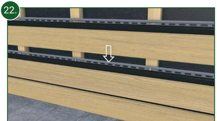
Die Fassadenprofile werden nun schrittweise aufeinandergestapelt und jeweils pro Profil nach den oben genannten Vorgaben befestigt.
