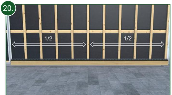
Jeweils mittig eines Fassadenprofils muss entgegen der in Bild 19 genannten Vorschriften pro Profil ein Fixpunkt gesetzt werden. Dieser Fixpunkt gewährleistet die gleichmäßige Ausdehnung der Fassadenprofile jeweils zur rechten und linken Seite.
