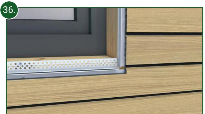
36. Klinken Sie Fassadenprofile in den Bereichen der Fensterleibungen am unteren und oberen Bereich der Fenster und Türen mit Hilfe einer Stichsäge aus.
