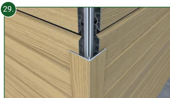
29. Oberteile des Eckprofils passend auf benötigte Länge zusägen und auf montierte Unterteile aufklipsen.
