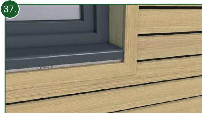
37. Sägen Sie nun die Oberteile der Abschlussprofile und des Lüftungsprofils zu (incl. Gehrungsschnitten) und klipsen diese auf die bereits montierten Unterteile. Bitte berücksichtigen Sie bei der Länge der Oberteile eine mögliche Profilausdehnung von ca. 3 mm pro Meter!
