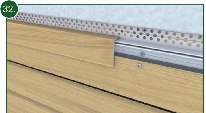
32. Das Oberteil des 2-teiligen oberen Lüftungsprofils wird exakt dem des Abschlussprofils montiert.
