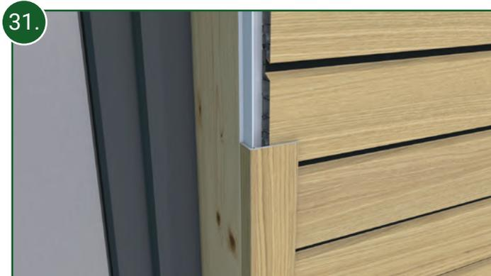
31. Montieren Sie das Oberteil des 2-teiligen Abschlussprofils exakt gleich, wie das des Eckprofils.
