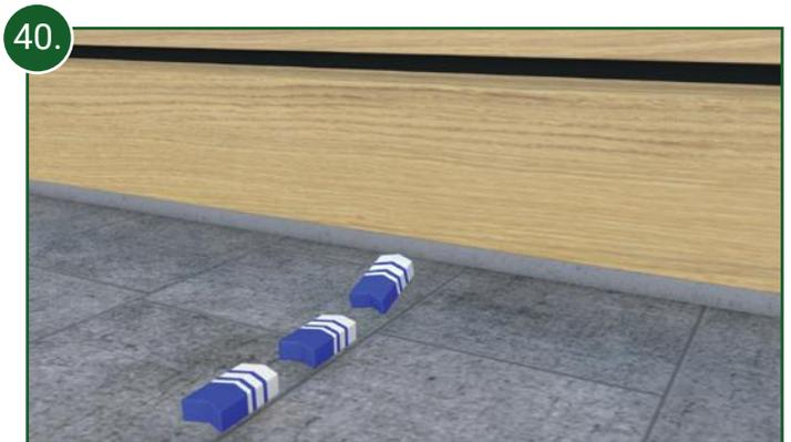
40. Das Prinzip der Hinterlüftung wird nun durch den Lufteintritt an der Unterseite der Fassade...
