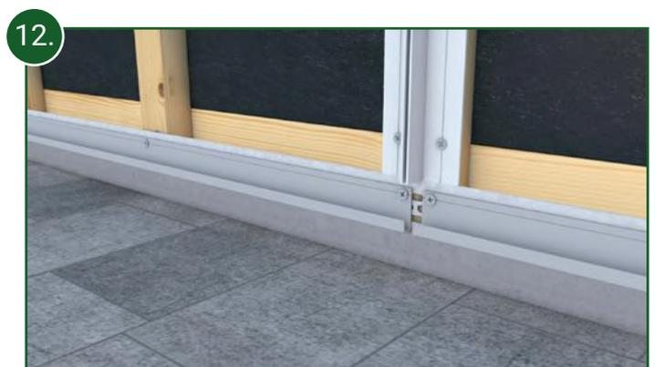
12. Fixieren Sie das Aluminium-Startprofil nun bündig mit der Unterkante des unteren Lüftungsprofils entlang des unteren Fassadenabschlusses mit Hilfe der eingebrachten Schraubnut. Achtung: Im Bereich der Verbindungsprofile müssen die Startprofile geteilt werden!
