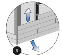
Das System enthält einen Belüftungsabstand zwischen dem tragenden Mauerwerk und den Paneelen und vermeidet so Hitzestau und Feuchtigkeitsbildung.
