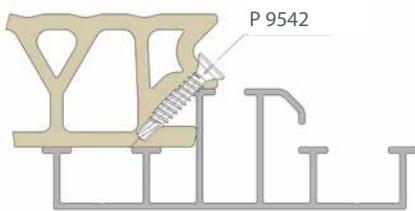
Vorbohrung 3 mm
