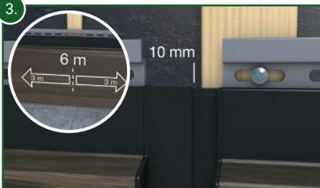
Fügen Sie nun die Fassadenprofile zusammen. Stellen Sie sicher, dass die Profile gemäß den Angaben der Montageanleitung mittig durch eine Schraube **zwischen 2 Langlöchern** fixiert sind. Bei der Montage von 6 m langen Profilen muss eine Dehnfuge von 10 mm eingehalten werden!
