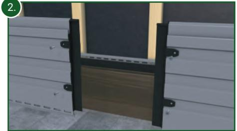
Stellen Sie sicher, dass die Verbinder bis zum Anschlag eingeschoben sind und fixieren Sie diese mit Hilfe der beigefügten Schrauben (4 Stück) auf den Rückseiten der Profile.
