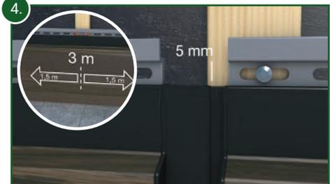
Bei der Montage von Fassadenprofilen mit Längen von 6 m kann die Breite der Dehnfuge auf 5 mm reduziert werden. Die genaue Position ist durch Markierungen auf dem unteren Verbinder gekennzeichnet.
