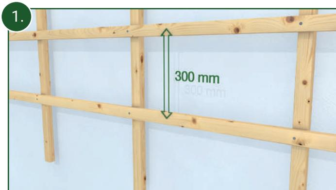
Die Unterkonstruktion besteht aus zunächst vertikalen Dachlatten 40 x 30 mm im Abstand von ca. 50 cm. Darüber montieren Sie die gleichen Dachlatten horizontal im Abstand von 30 cm. Am unteren und oberen Fassadenrand wird zunächst keine horizontale Dachlatte angebracht.
