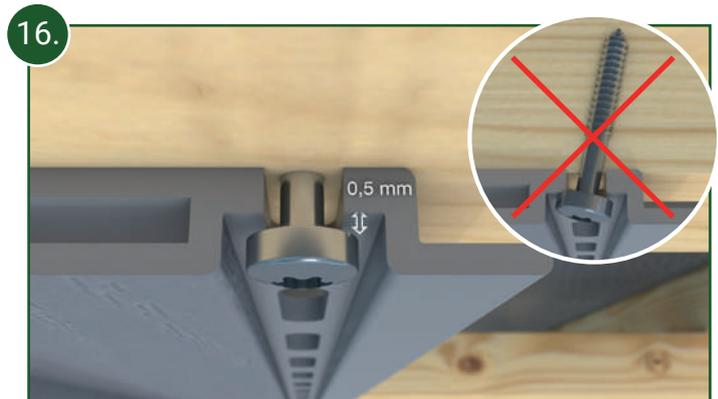
16. Achten Sie darauf, dass die Schrauben gerade und nur soweit eingedreht werden, dass die Profile den nötigen Spielraum für die Ausdehnung behalten.
