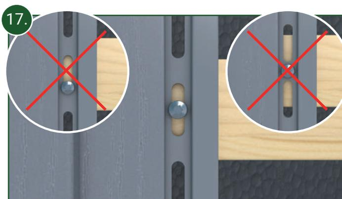
17. Die Positionierung der Fassadenschrauben muss möglichst mittig in den Langlöchern erfolgen. Bei ungünstigen Verhältnissen sollte die vorhandene Traglattung nochmals oben oder unten durch kleine Holzstücke aufgefüttert werden.
