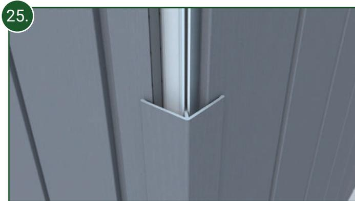
25. Sägen Sie nun die Oberteile der Eckprofile auf die benötigten Längen zu und klipsen diese dann auf die bereits montierten Unterteile auf. **ACHTUNG:** Berücksichtigen Sie bitte eine Längenausdehnung von ca. 3 mm pro Meter! Die Schenkel sollen nach dem Aufklipsen eng an den Fassadenprofilen anliegen.
