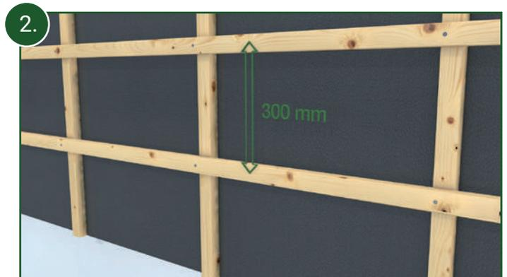
Achten Sie bei gedämmten Fassadenflächen darauf, dass die vertikale Lattung auf die Dämmplatten montiert werden. Es muss in jedem Fall ein Luftspalt von mindestens 6 cm Breite (2 volle Dachlattenstärken a 30 mm) hinter der Fassadenfläche gewährleistet werden.
