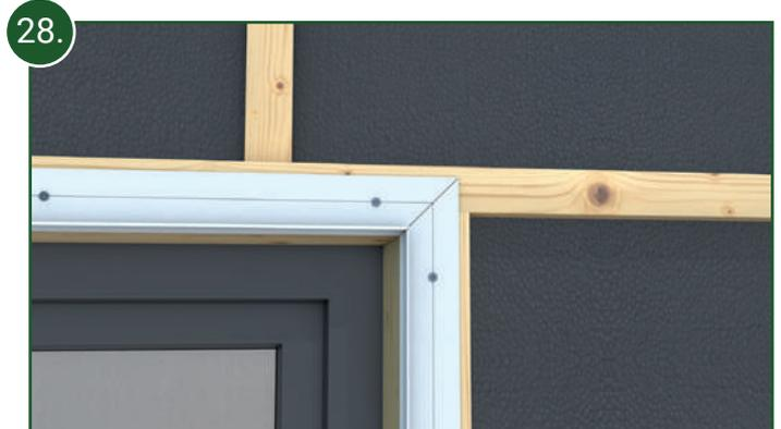
28. Montieren Sie die Unterteile der 2-teiligen Abschlussprofile bündig entlang der Fensterleibung. Die Eckverbindungen erfolgen per Gehrungsschnitt. Zur vollflächigen Auflage der Unterteile müssen die vertikalen Dachlatten aufgefüttert werden.
