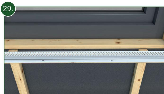
29. An der Unterseite der Fensterbank verschrauben Sie ein Unterteil des 2-teiligen oberen Lüftungsprofils, damit auch in diesem Bereich eine Entlüftung gewährleistet ist. Auch hier muss die horizontale Dachlatte mit Abstand 25 mm zum oberen Abschluss positioniert werden.
