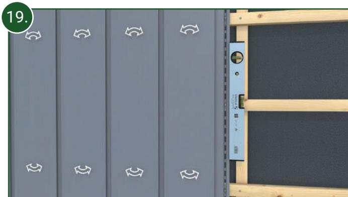
19. Die exakte Ausrichtung der Fassade sollte in regelmäßigen Abständen mit Hilfe einer Wasserwaage kontrolliert werden. Kleine Korrekturen sind jeweils beim Zusammenstecken der Profile möglich.
