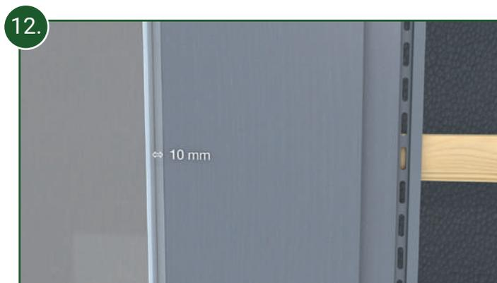
12. Achten Sie beim Montagestart der Fassadenprofile auf einen Abstand von 10 mm zwischen Profil und dem äußeren Ende der Abschlussprofile.
