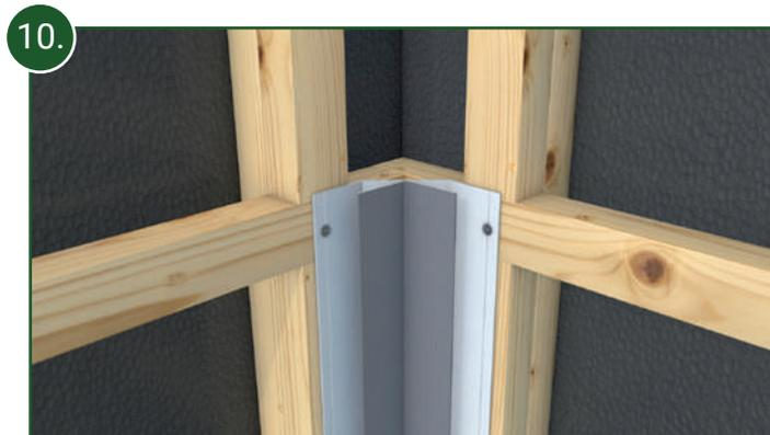
10. Das variable Eckprofil wird mit Schrauben entlang der eingebrachten Schraubnuten im Abstand von 40 cm in den Traglatten fixiert. Auch hier muss durch Auffütterung mit Hilfe weiterer Dachlatten eine vollflächige Auflage der Profilflächen gewährleistet sein!
