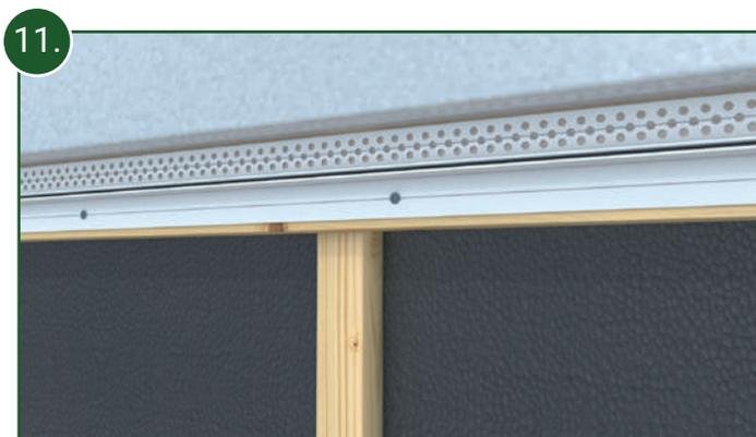
11. Die oberste horizontale Dachlatte verschrauben Sie mit einem Abstand von 25 mm zum oberen Fassadenabschluss. Hierauf wird anschließend das Unterteil des 2-teiligen oberen Lüftungsprofils in regelmäßigen Abständen von 40 cm montiert.
