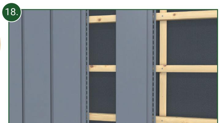
18. Die Fassadenprofile werden nach dem vorgenannten Schema nun schrittweise längseitig nebeneinander montiert.
