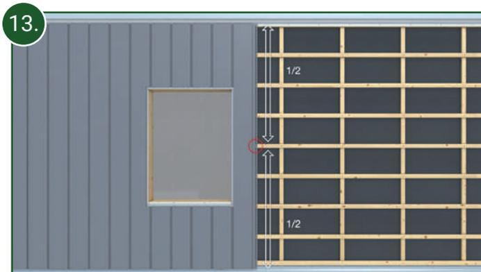
13. **ACHTUNG:** Um die Längenausdehnung der Fassadenprofile nach oben und unten zu kontrollieren, muss jedes Profil einmal mittig fixiert werden!
