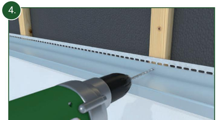
Montieren Sie das Aluminium Abtropfprofil nun mit dem Schenkel 25 mm bündig mit dem unteren Ende der vertikalen Dachlatte.
