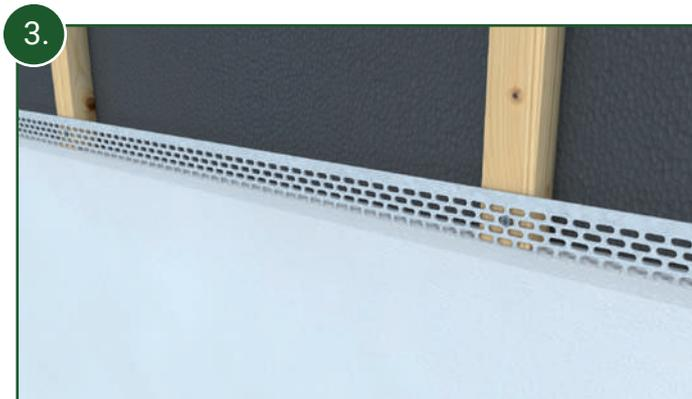
Fixieren Sie nun das Lüftungsprofil 40 x 30 mm mit den vertikalen Dachlatten am unteren Fassadenabschluss.
