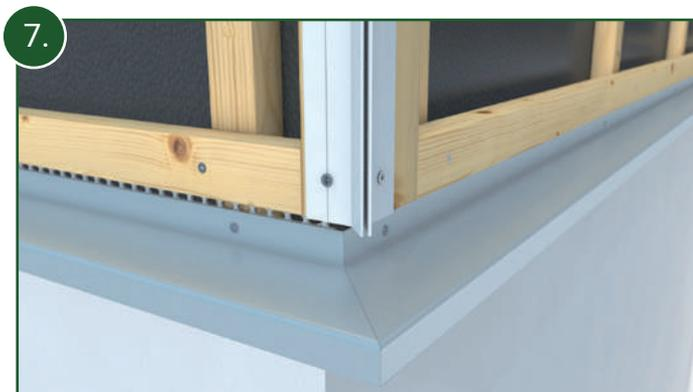
7. Verschrauben Sie nun die Unterteile der Außeneckprofile in allen Eckbereichen im Abstand von 40 cm entlang der eingebrachten Schraubnuten. Füttern Sie hierfür die Auflageflächen zwischen der horizontalen Traglattung entsprechend mit weiteren Dachlatten auf.
