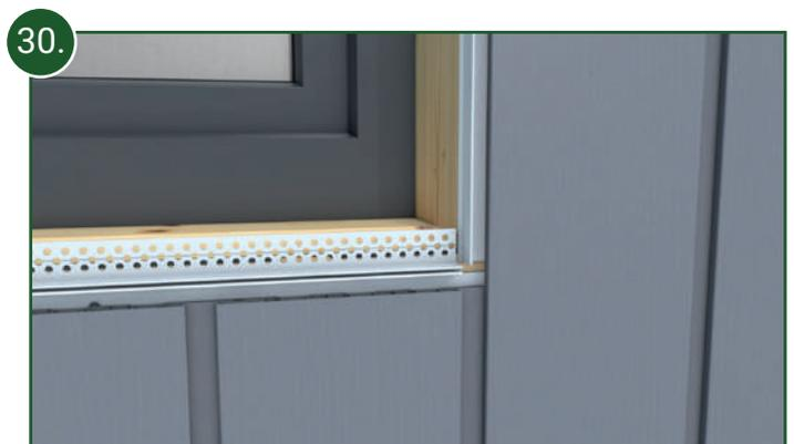
30. Klinken Sie die Fassadenprofile notfalls am linken und rechten Bereich des Fenster- oder Türausschnittes mit Hilfe einer Stichsäge aus.
