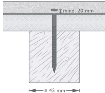
Befestigung mit Schraube HO 5 x 60 mm auf Holz-Unterkonstruktion. Die Cedral Dielen sind mit  $\varnothing 6,0$  mm vorzubohren. Ein Randabstand von mind. 20 mm ist einzuhalten.
