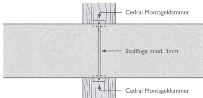
Ausbildung der Stoßfugen auf einem Auflager bei nicht sichtbarer Befestigung mit Cedral Montageklammern
