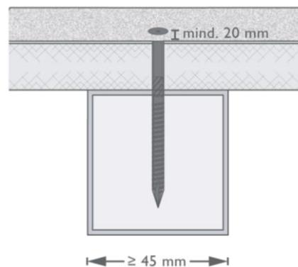
Befestigung mit Schraube AL 5 x 60 mm auf Aluminium-Unterkonstruktion. Die Cedral Dielen sind mit  $\varnothing 6,0$  mm vorzubohren. Ein Randabstand von mind. 20 mm ist einzuhalten.
