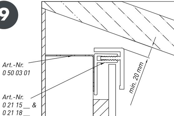
Auch die Zubehörprofile unterliegen bei Temperaturerhöhungen einer Wärmeausdehnung. Es ist unbedingt darauf zu achten, dass an den Profilenenden zu anderen feststehenden Bauteilen genügend Raum für die Ausdehnung vorhanden ist. Die Oberteile von senkrecht montierten 2-teiligen Zubehörprofilen sind gegen Abrutschen im oberen Bereich, z. B. mit Montagekleber oder Schrauben, zu fixieren.
