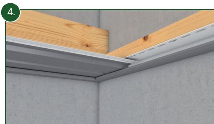
Nun können Sie die Verkleidungsprofile in die Aufnahme der Abschlussprofile einführen und bis zum Startpunkt durchschieben.
