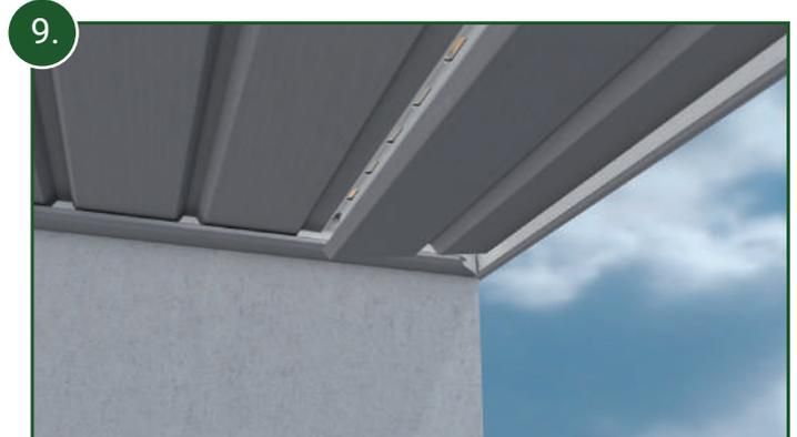
9. Das längsseitig gekürzte Verkleidungsprofil wird mit der langen geschnittenen Seite in die Aufnahme des Abschlussprofils geschoben und dann wieder zurück auf die Feder des vorletzten Verkleidungsprofils gedrückt. Das Abschlussprofil kann zur Vereinfachung leicht nach unten gebogen werden.
