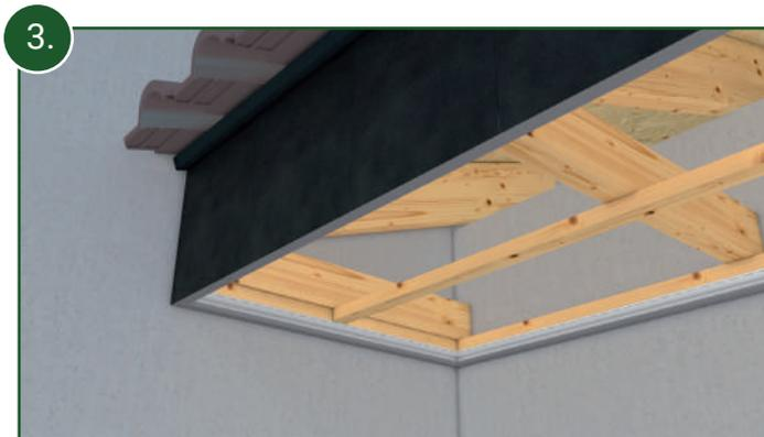
Der Hartschaumwinkel kann zur Vereinfachung auch zum Schluss montiert werden. Dieser wird mit den Schrauben mit gefärbtem Kopf (DD005) oder den Polytopnägeln (DD010) befestigt.
