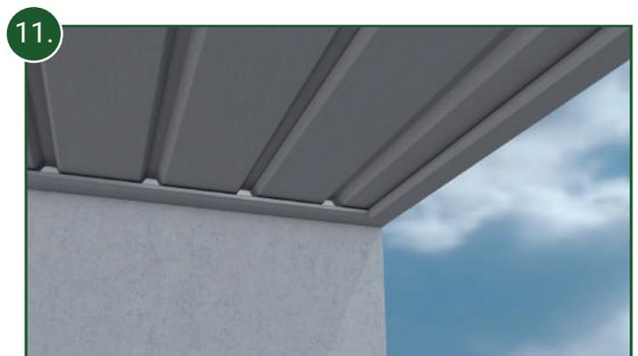
11. Die Schrauben werden durch das Abschlussprofil verdeckt und sind nicht sichtbar.
