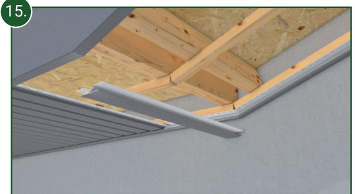
15. Um eine Steigung bei dem Dachüberstand zu verkleiden wird das variable Eckprofil (DD220) verwendet. Dieses ist knickbar und dadurch vielseitig einsetzbar.
