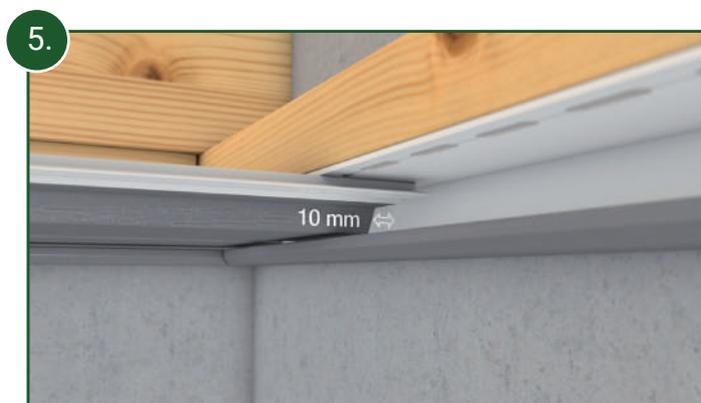
Vermitteln Sie das Verkleidungsprofil zwischen den beiden gegenüberliegenden Abschlussprofilen mit einem Dehnabstand von 10 mm beidseitig.
