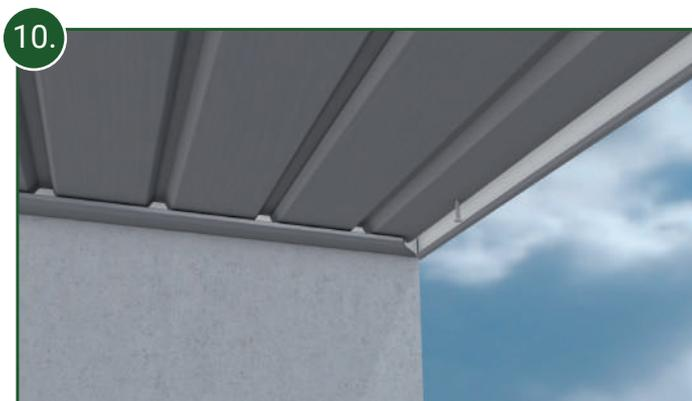
10. Da bei dem letzten Verkleidungsprofil die Feder mit den Schraublöchern abgesägt wird, muss dort durch die Hohlkammer des Verkleidungsprofil geschraubt werden. Zur einfacheren Handhabung kann das Abschlussprofil leicht nach unten gebogen werden.
