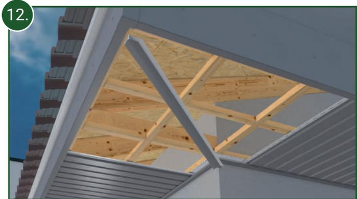
12. Bei der Verkleidung des Dachüberstands um eine Ecke wird das Verbindungsprofil (DD230) benötigt. Das Verbindungsprofil muss an beiden Enden passend zugesägt werden, da es nicht in die Aufnahme des Abschlussprofils geschoben werden darf. Auf einem Ende wird das Verbindungsprofil eingekerbt und auf der anderen Seite wird es spitz zugesägt.
