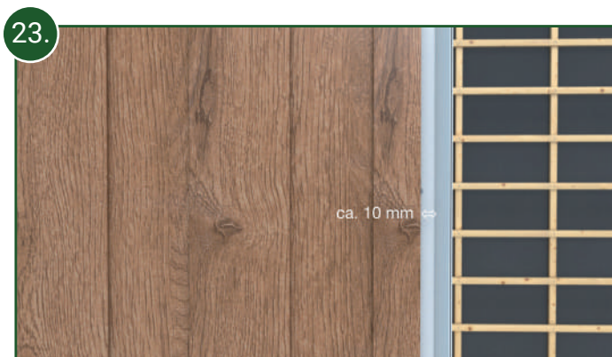
23. Der Abstand der Sägekante zum äußeren Ende des 2-teiligen Abschluss- oder Eckprofils muss 10 mm betragen.
