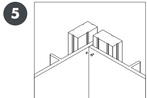
Für die Naturecken werden die Profile aneinander gestoßen und mit Fassadennägeln (Art.-Nr. 0 51 04 02) alle 10 cm auf ein Distanzprofil montiert.
