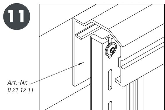
Alternativ kann für vinyStone zur Schnittkantenabdeckung ebenfalls das Abschlussprofil 45/39 verwendet werden. Zur Entlüftung muss dann ein ausreichender Abstand von mindestens 5 mm zu angrenzenden Bauteilen belassen werden.
