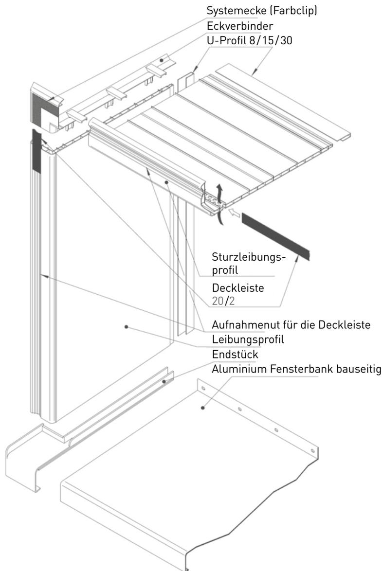
Für die Entlüftung der Fassade unter der Fensterbank muss zwischen der Oberkante des vinylTherm/vinylStone Profils und der Unterkante der Fensterbank ein Spalt von mindestens 5mm belassen werden. Um Verschmutzungen der Fassadenoberfläche zu vermeiden, empfehlen wir einen Fensterbanküberstand von 3 – 4 cm und den Einbau von Fensterbankendstücken (Art.-Nr.: 0 63 60 \_\_).
