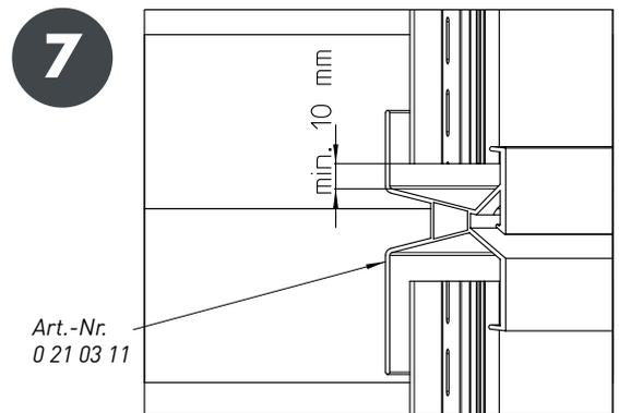
Bei einer Profillänge über 6 m kann vinylTherm durch das X-Profil Stirnseitig verbunden werden. Hierbei muss genügend Freiraum vorhanden sein, um die Hinterlüftung zu gewährleisten.
