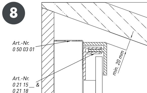
Auch die Zubehörprofile unterliegen bei Temperaturerhöhungen einer Wärmeausdehnung. Es ist unbedingt darauf zu achten, dass an den Profilenden zu anderen feststehenden Bauteilen genügend Raum für die Ausdehnung vorhanden ist. Die Oberteile von senkrecht montierten 2-teiligen Zubehörprofilen sind gegen Abrutschen im oberen Bereich, z. B. mit Montagekleber oder Schrauben, zu fixieren.
