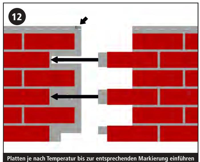
Platten je nach Temperatur bis zur entsprechenden Markierung einführen
