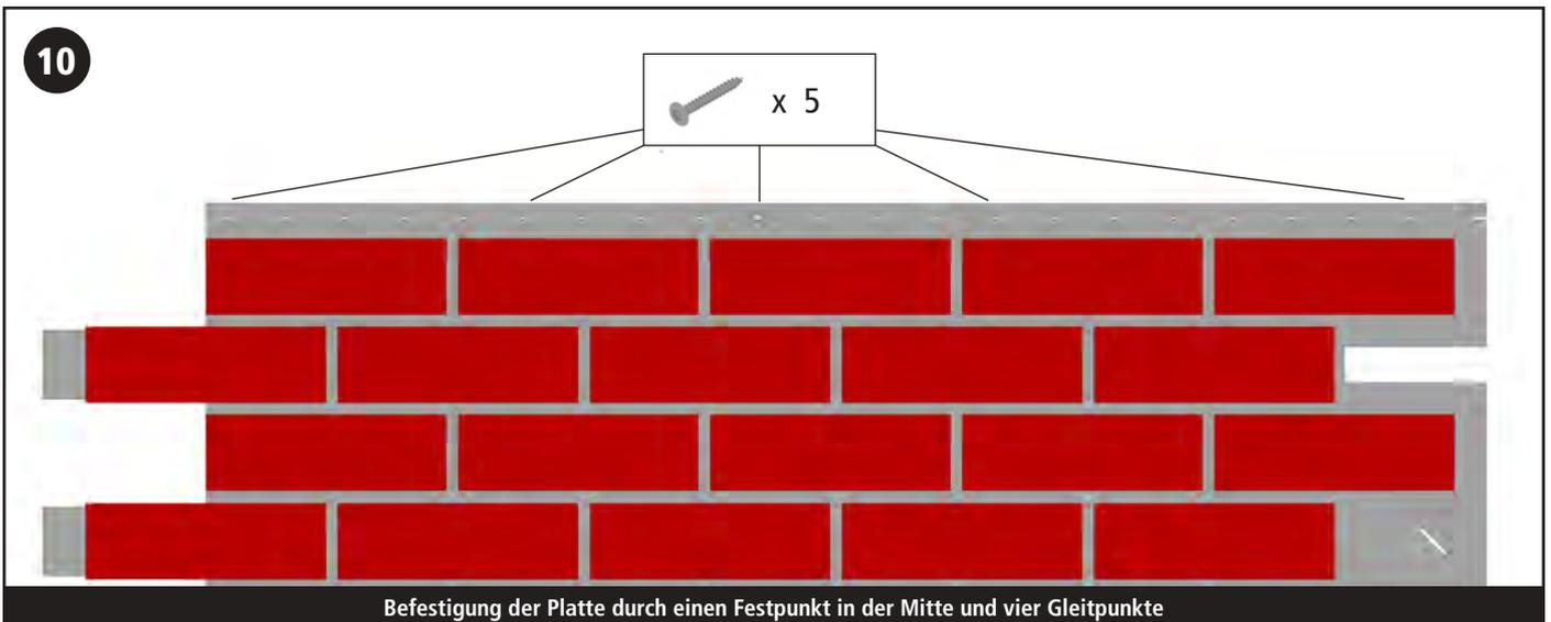
Befestigung der Platte durch einen Festpunkt in der Mitte und vier Gleitpunkte
