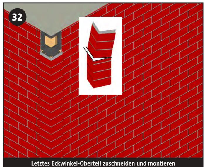
Die letzte Reihe der Elemente, wird so zugeschnitten, dass nach dem einsetzen ein Abstand von mindestens 6,4 mm zum oberen Lüftungsprofil besteht.
