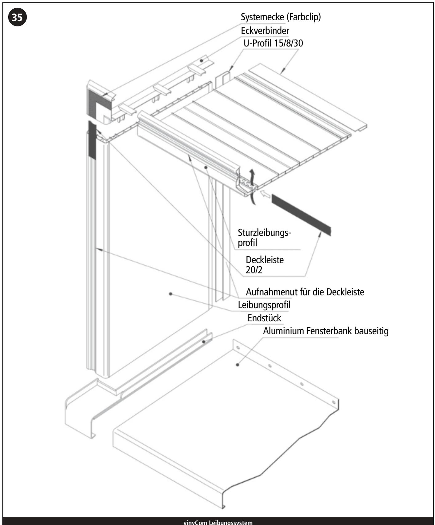
Soll die Leibung mit den Fassaden-Elementen ausgeführt werden, wird am Fenster-/ Türrahmen ein U-Profil befestigt.
