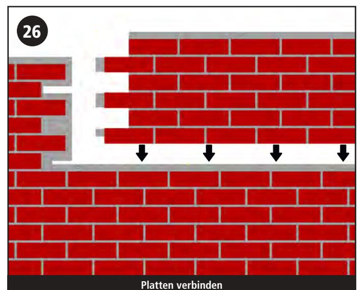
Es muss darauf geachtet werden, dass die Oberkante der Fassadenplatten bündig mit der Oberkante der Ecke ist.
