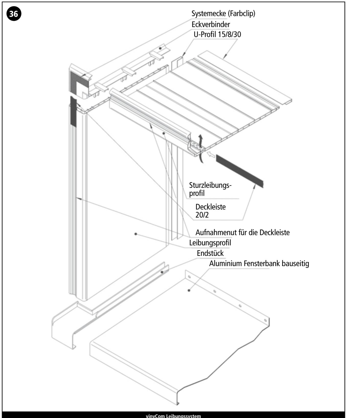
Soll die Leibung mit den Fassaden-Elementen ausgeführt werden, wird am Fenster-/ Türrahmen ein U-Profil (z.B. Protektor, o.ä.) befestigt.
